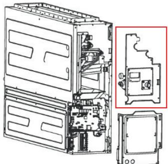
4. Retirer les quatre (4) vis encerclées en rouge et faire pivoter l'ensemble de la pompe de 90 degrés. Réinstaller les vis.
