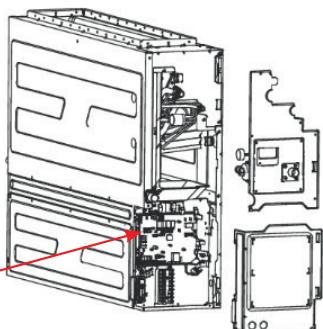
3. Retirer la plaque de fixation de la pompe de condensat.
