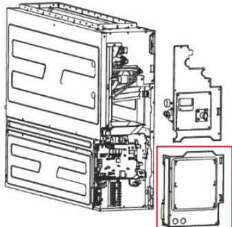
2. Débrancher la pompe de condensat (CN13) et l'interrupteur de niveau d'eau (CN5) de la carte principale de l'unité intérieure.
