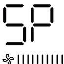
Lorsque l'unité de climatisation est éteinte, dans la fonction de demande de température, appuyez sur « ^ » ou « v » pour sélectionner SP, appuyez sur « CONFIRMATION » pour ajuster la valeur de pression statique.
