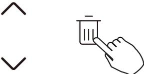
Appuyez sur « ^ » ou « v » pour sélectionner le temps de réglage qui veut supprimer. Le temps, le mode, la température et la vitesse du ventilateur apparaissent sur le LCD. Le temps, le mode, la température et la vitesse du ventilateur peuvent être supprimés en appuyant sur le DEL (jour d'arrêt).
