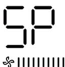
Si l'unité de climatisation est éteinte, dans la fonction requête de la température, appuyez sur «  $\wedge$  » ou «  $\vee$  » pour sélectionner SP, appuyez sur « Confirm » pour régler la valeur de la pression statique.
