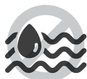
NE PAS installer l'unité d'intérieur dans un environnement humide. Une humidité excessive peut corroder l'équipement, les composants électriques et provoquer des courts-circuits électriques.
