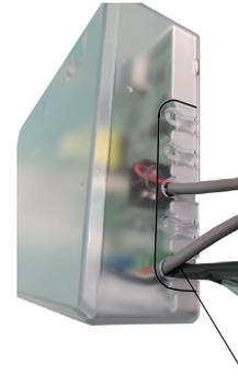
Coupez la partie appropriée selon la position pour la sortie des fils. Dans le cas d'un seul fil, vous pouvez découper un trou pour un seul fil. Dans le cas de plusieurs fils, vous pouvez découper le couvercle le long du contour maximal.
