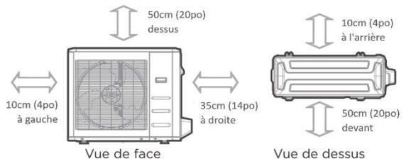
Remarque : Les unités extérieures doivent être surélevées de 30,5-61 cm (12-24 po) au-dessus de la surface inférieure dans les applications de chauffage pour permettre l'évacuation de la neige et l'écoulement du dégivrage. Suivez les codes locaux, les meilleures pratiques et les directives. Diagrammes à titre de référence seulement.
